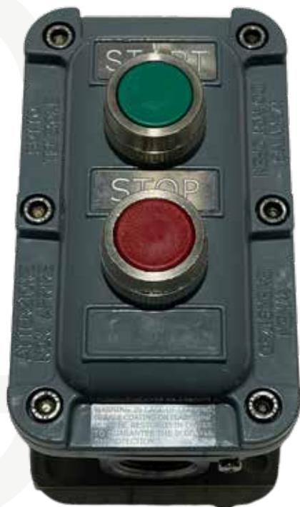
Boîtier de commande marche-arrêt antidéflagrant pour utilisation en zone dangereuse. Boîtier Ex d équipé d'un bouton poussoir vert 2NO et d'un bouton poussoir rouge 2NF, muni de 2 presse-étoupes 3/4" NPT.
